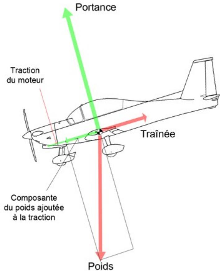
Le poids comprend dans ce cas une composante parallèle au vent relatif mais qui s'ajoute à la traction, ou qui remplace la traction dans le cas du vol en palier sans moteur ou moteur réduit.
